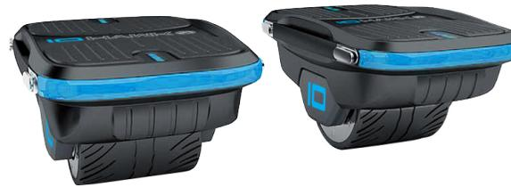
Die IO HAWK NXT Skates sind mit einer Auto-Balance Funktion ausgestattet, die die einzelnen Skates aufrecht halten, auch wenn kein Fahrer drauf steht. So wird ein leichtes Auf- & Absteigen ermöglicht.
