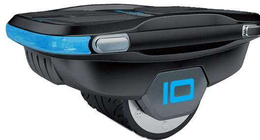
Damit deine IO HAWK NXT Skates nicht nur an der Vorder- & Rückseite geschützt sind, befinden sich an den Seiten zusätzliche Stoßfänger, welche gleichzeitig als Trageriemen funktionieren. So kannst Du deine Skates überall leicht mit hinnehmen.
